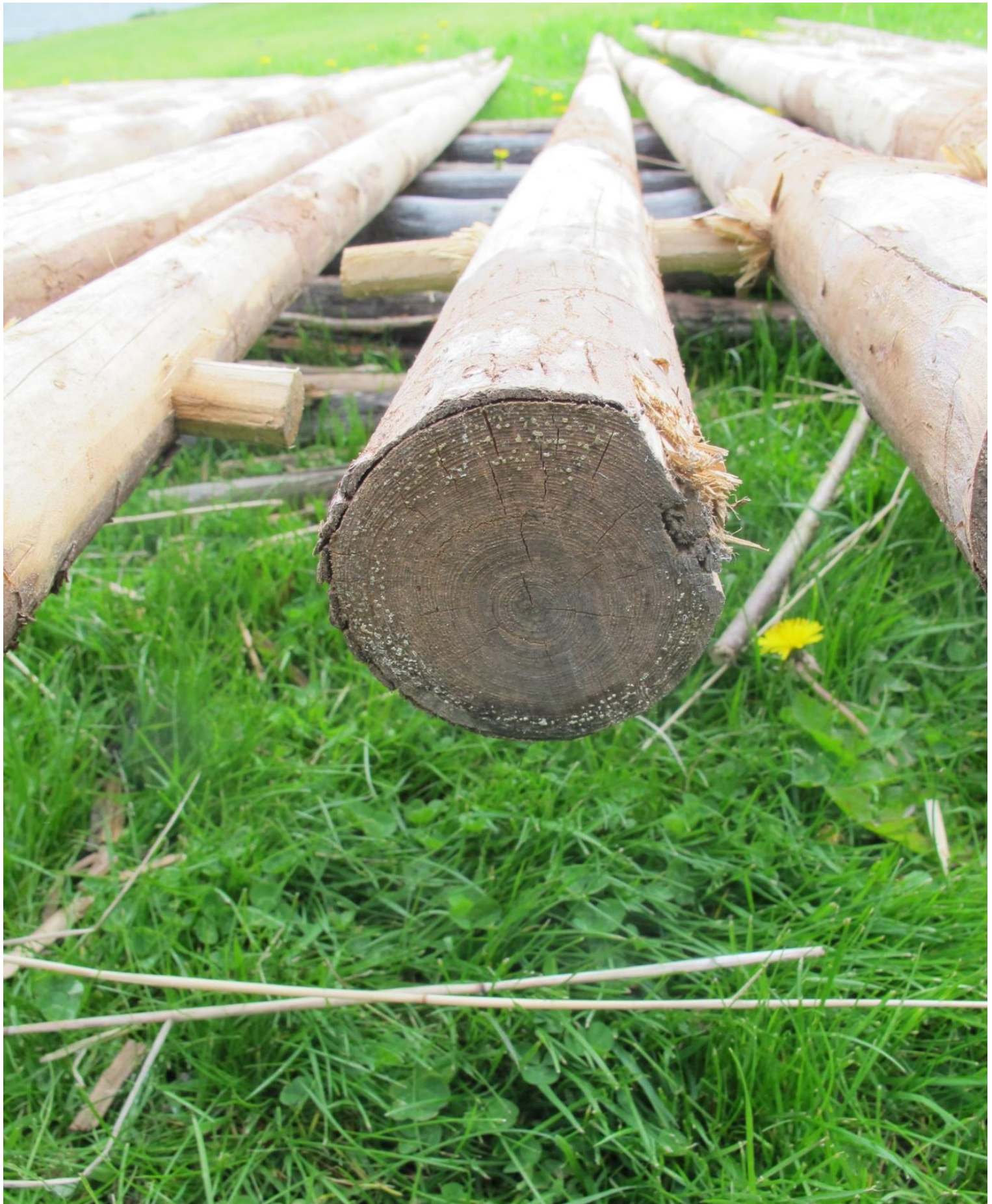
LP_2015_00113. 60 nya avbarkade slador av undertryckt gran tillverkades. Foto H. Bellberg
